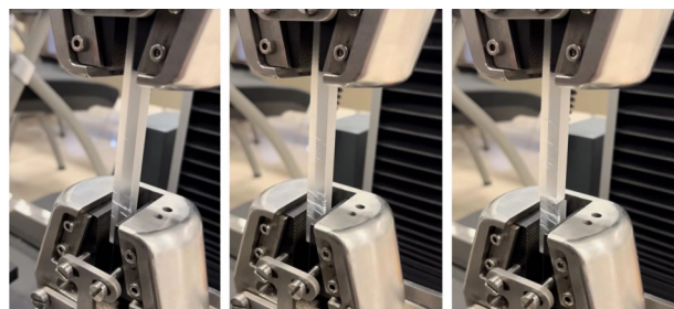
a—拉伸初始; b—拉伸中期(裂纹扩展); c—拉伸后期(断裂)
